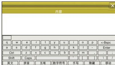
Экран содержит программную клавиатуру. Как показано на рисунке, можно выбрать метод ввода из последней кнопки внизу; нажать кнопку "Handwrite" (Рукописный ввод), чтобы изменить состояние рукописного ввода; и нажать кнопку "Hide" (Скрыть), чтобы закрыть небольшую клавиатуру. Окно рукописного ввода выглядит следующим образом:
