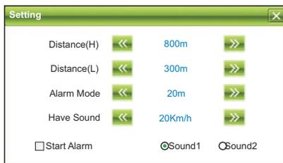
Установить флажок "Start Alarm" (Включить оповещения). Флажок в квадратной рамке означает, что электронная предупреждающая система включена. "Distance(H)"
