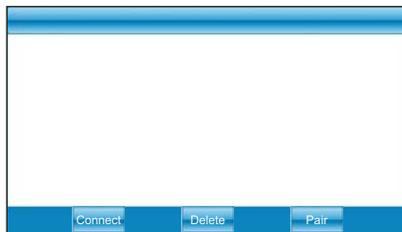
Если подключение было установлено в прошлом, то в данном окне будут перечисляться все ранее подключенные устройства. Выбрать устройство и нажать кнопку Connect (Подключить), чтобы подключить устройство. Процесс подключения занимает несколько минут. Будьте терпеливы. Нажать кнопку Delete (Удалить), чтобы удалить все подключенные записи.
